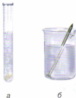
Рис. 15. Выделение газа: а — взаимодействие карбоната кальция \text{CaCO}_3 с соляной кислотой \text{HCl} ; б — взаимодействие железа \text{Fe} с раствором серной кислоты \text{H}_2\text{SO}_4
