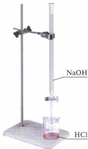
Рис. 50. Прибор для проведения реакции нейтрализации
