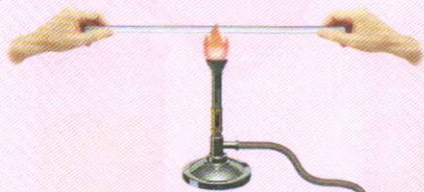
Рис. 17. Сгибание стеклянной трубки
