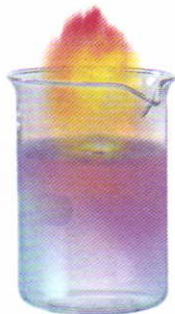
Рис. 49. Взаимодействие калия с водой, содержащей фенолфталеин
