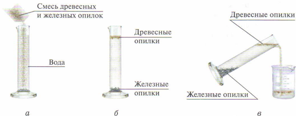
Рис. 25. Отделение железных опилок от древесных: a — высыпание смеси железных и древесных опилок в воду; б — разделение смеси в воде; в — сливание воды с всплывшими древесными опилками
