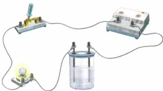
Рис. 35. Прибор для наблюдения электропроводности веществ
