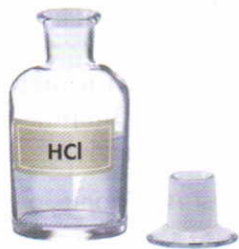
Рис. 56. Положение пробки при использовании реактивами
